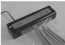
6. Когда мотор остановится, индикатор кнопки «Start» загорится постоянным синим цветом, а кнопка «Seal» погаснет. **Обратите внимание:** аппарат автоматически откроет клапан вакуумной камеры и сравняет давление в камере с атмосферным.
