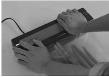
4. Закройте крышку. Слегка надавите на нее двумя руками по бокам. Удерживайте пару секунд кнопку «Start» для активации функции «вакуум + запайка», индикатор кнопки «Start» будет мигать синим.
