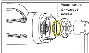
3. Подсоедините блок ножей с уплотнителем ко дну стакана и плотно затяните фиксатор ножей.
