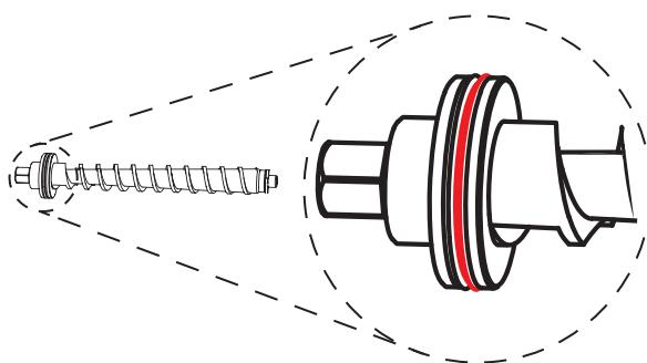
**Внимание!** Во время мойки шнека проверяйте состояние уплотнителя, препятствующего попаданию масла на вал двигателя. Уплотнитель подвержен естественному износу и его состояние требует периодической проверки. При появлении признаков износа уплотнителя, таких как следы масла на корпусе или в месте фиксации шнека, требуется незамедлительная замена уплотнителя.
