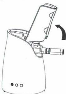
Поднимите переднюю крышку отжимной корзины.
