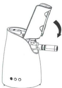
3. Переведите фиксатор отжимной корзины в закрытое положение (символ ) и затем установите загрузочную камеру.
