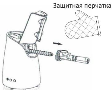
Снимите отжимную корзину со шнеком. Детали могут быть горячими! Используйте защитную перчатку, входящую в стандартный комплект поставки прибора!
